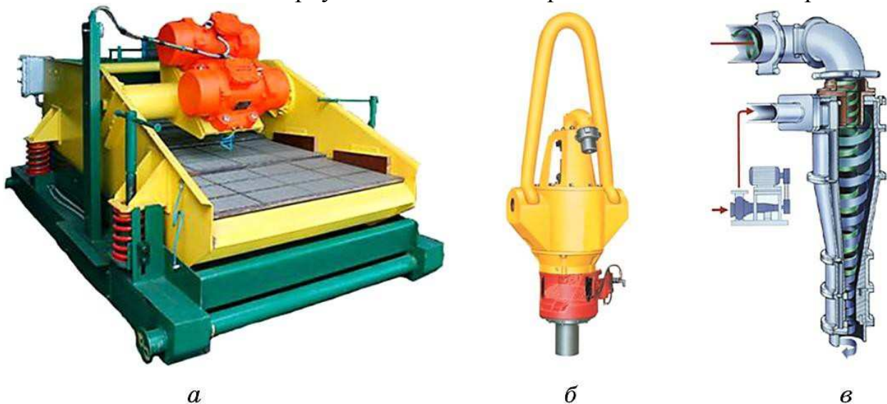
Рис. 3.2. Елементи промивальної установки бурильної колони: а — вібрисито, б — вертлюг, в — гідроциклон.
